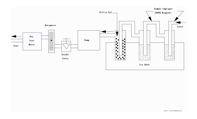
FIGURE 1. TYPICAL SAMPLING SYSTEM
