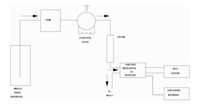
FIGURE 3. TYPICAL HPLC SYSTEM
